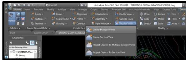
Figura 56. Creación se vistas de sección
