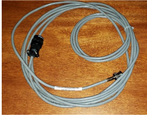
Figura 8: Cables de transductor de presión
