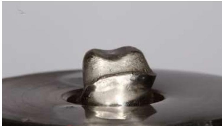
**Figura 3.7.-Muñón metálico para prueba de compresión**
