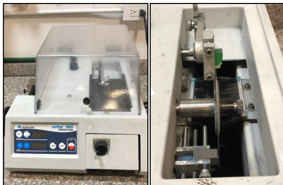
Figura 11. Isomet 1000 (Buehler) (Universidad San Francisco de Quito) y colocación de la muestra previo al corte sagital.
