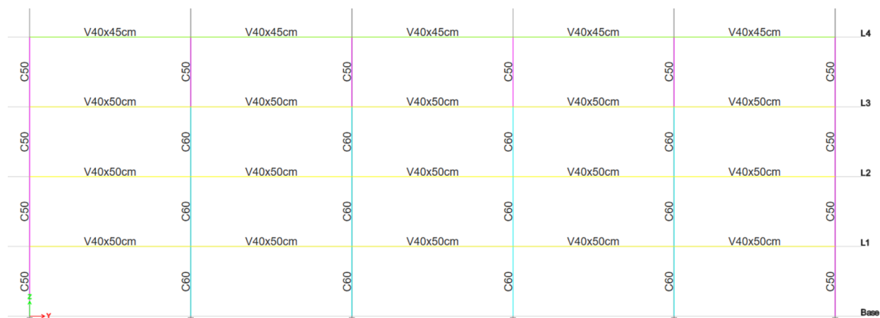
Figura 45. Configuración de las secciones en un pórtico interior en dirección “y” para un edificio de 4 pisos para \Delta_M = 2.0\%
