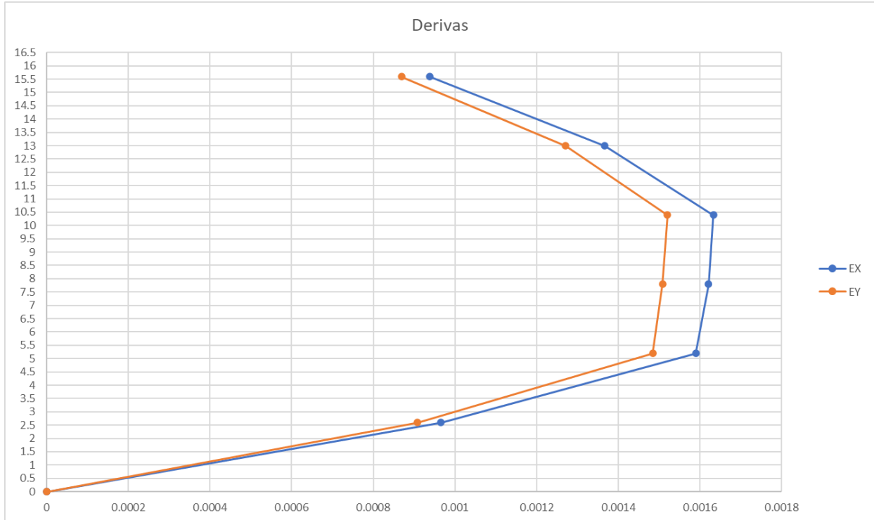
Figura 74. Grafica de las derivas elásticas en cada losa del edificio de 6 pisos para \Delta_M = 1.0\% .
