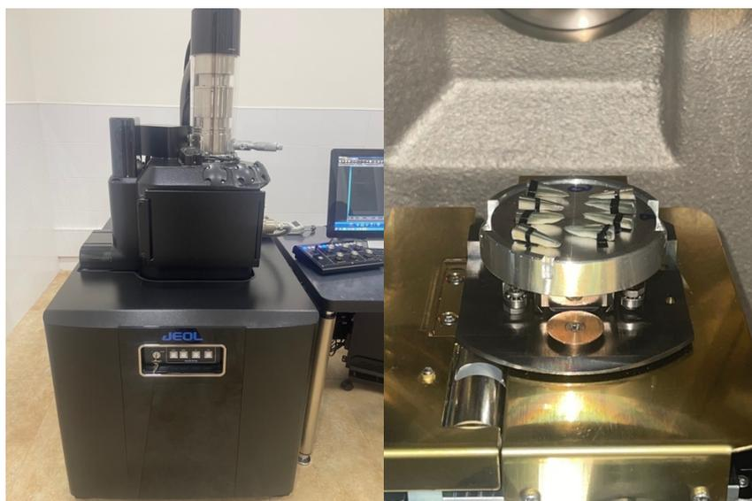
**Figura 12.** Microscopio electrónico de barrido
