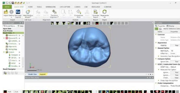
Figura 10: Comparación de mallas en el software Geomagic Control X 64
