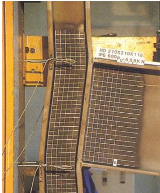
Figura 25. Se observa que la zona de panel se comporte de esta manera. Fuente. Hernández, Revisión y aplicación de la zona de panel en los pórticos resistentes a momento de acero. 2019. Vía web.
