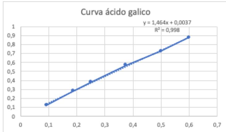
Figura 12. Curva estándar de Ácido Gálico. (x) mM de Ácido Gálico (y) Abs 510 nm
