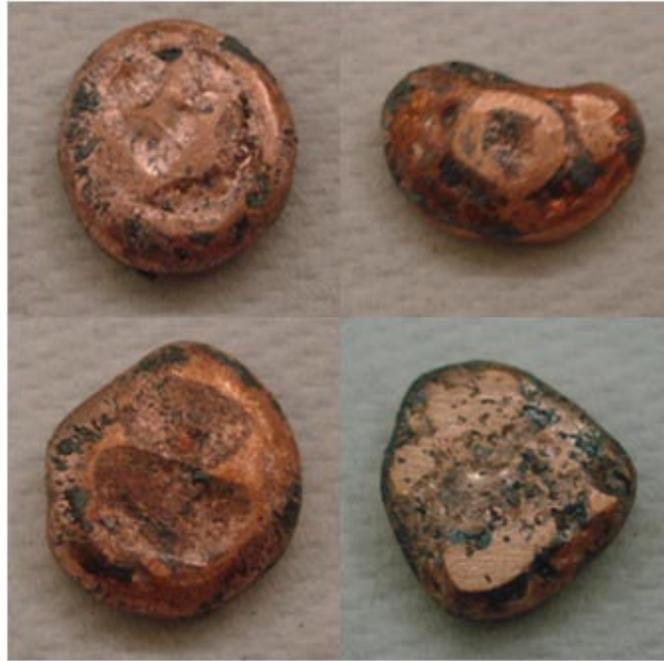
**Figura 2.4.** Fotografías de fases metálicas compuestas principalmente por cobre, oro y plata obtenidas durante esta investigación.
