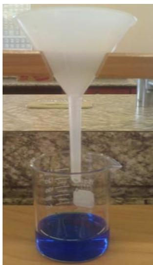
**Figura 4.16.** Fotografía en la cual se observa la solución de nitrato de cobre y nitrato de plata recuperada por filtración.
