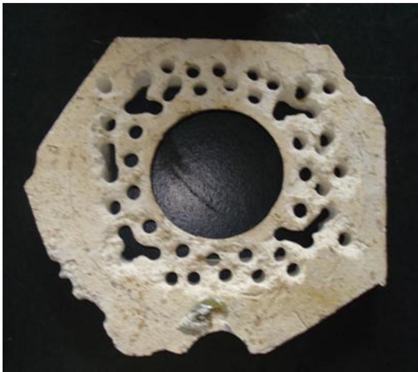
**Figura 4.23.** Soporte hecho a partir de un material reciclado de arcilla refractaria.
