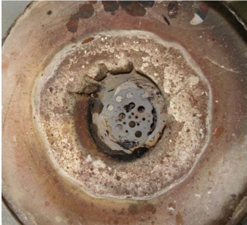
**Figura 4.22.** Primer soporte probado en el horno hecho a partir de un material reciclado de arcilla refractaria.
