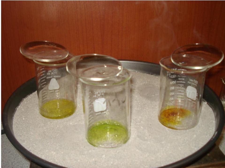
**Figura VIII.1.** Fotografía de tres muestras de fase escoria durante la disgregación ácida.
