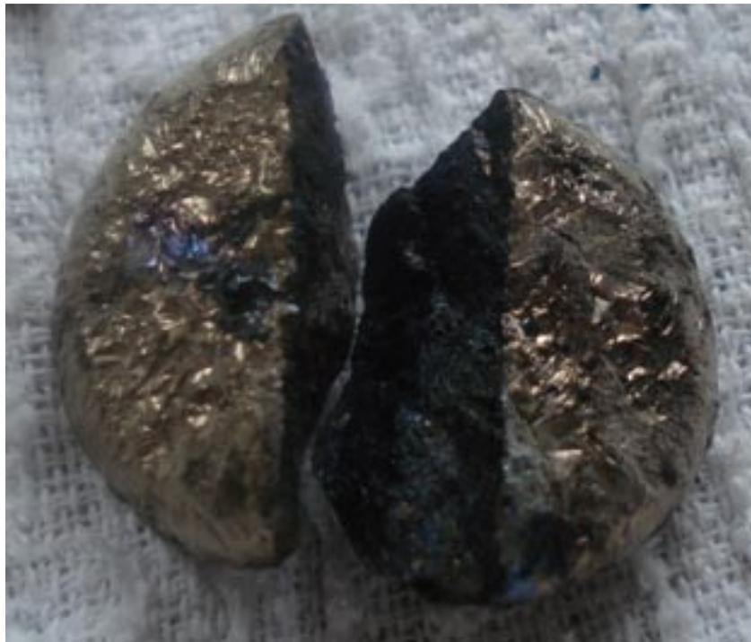
**Figura 2.2.** Fotografía de una fase mata generada en la fusión de un concentrado de sulfuros de cobre y hierro.
