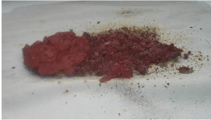
**Figura 4.4.** Polvo de cobre metálico recuperado.
