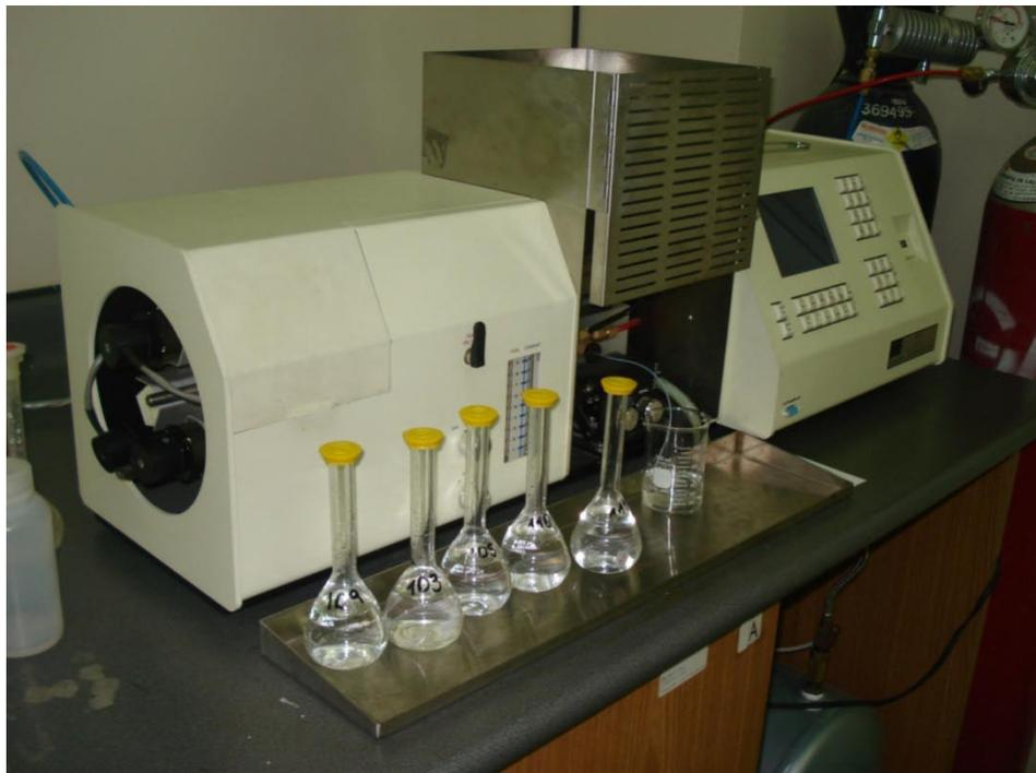
**Figura VIII.2.** Fotografía de las soluciones de fase escoria obtenidas por medio de disgregación ácida siendo analizadas por EAA en el laboratorio del departamento de Ingeniería Química de la USFQ.
