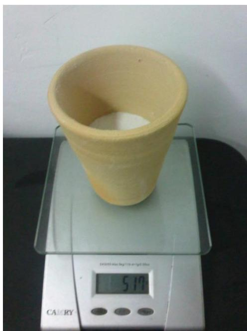
**Figura 4.9.** Fotografía del crisol que contiene la carga fundente, que indica la altura máxima de la carga fundente en el crisol para que no exista derrames en el horno.
