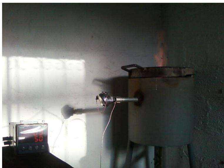
**Figura 4.26.** Fotografía del horno de fusión en funcionamiento después de instalar la termocupla.
