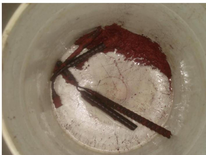
**Figura 4.3.** Cobre metálico en polvo recuperado.
