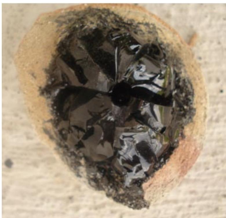
**Figura 2.1.** Fotografía de la fase escoria generada por fusión de una mezcla de óxidos de cobre y hierro, utilizando bórax como principal agente fundente.
