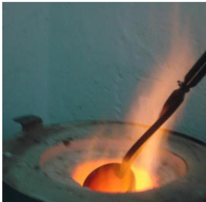
**Figura 4.8.** Fotografía del horno de fusión en funcionamiento.
