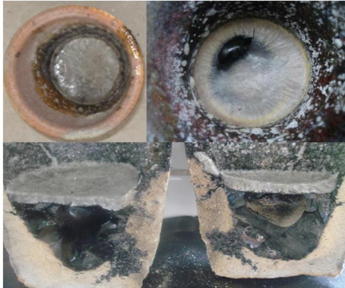
**Figura 4.19.** Fotografías de capas de sulfatos formadas sobre la fase escoria después de la primera etapa de fundición.
