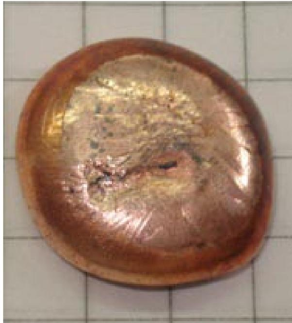
**Figura 4.28.** Fase metálica compuesta de oro, cobre y plata obtenida en el Ensayo # 88
