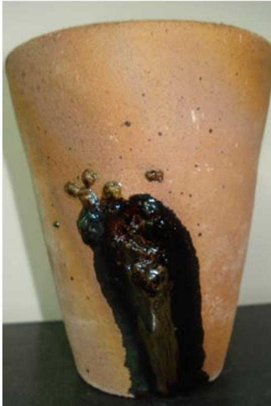
**Figura 4.21.** Fotografía de la ruptura de un crisol debido a la acción del  $\text{NaHCO}_3$  sobre la sílice del crisol, y a la posición del crisol dentro del horno.
