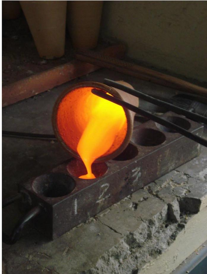
**Figura 2.10.** Fotografía de una carga fundente que cumple con las consideraciones básicas de la formación de escorias, obteniendo así una mezcla bastante fluida.
