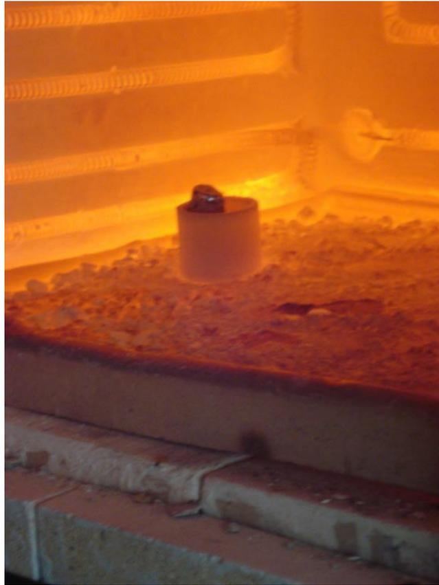
**Figura 1.5.** Fotografía del interior de un horno que muestra un régulo de plomo obtenido por fusión, el cual se encuentra sobre una copela.
