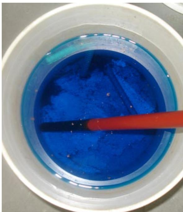
**Figura 4.1.** Preparación de cobre metálico en polvo por medio de sulfato de cobre y varillas de hierro en medio ácido.
