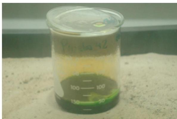
**Figura 4.14.** Fotografía en la cual se disuelve una fase metálica en ácido nítrico sobre una cama de arena.
