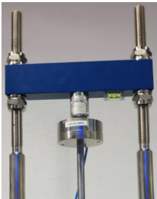
Ilustración 27: Acople vástago con celda de carga
