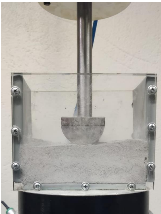
Ilustración 35: Imagen previa al contacto entre cilindro y estrato de suelo
