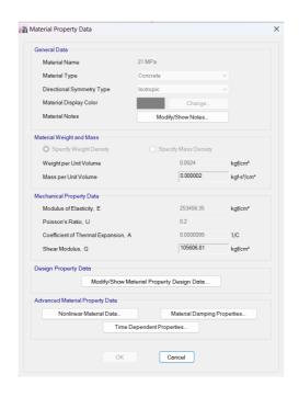
Ilustración 48: Hormigón 21MPa.
