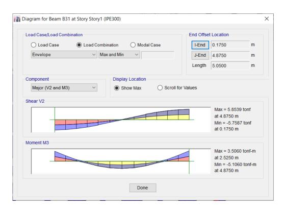
Ilustración 35: Diagramas viga B31.
