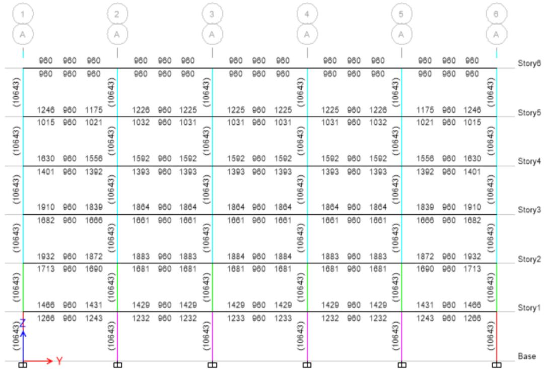
Ilustración 18: Refuerzo en vigas, eje A.
