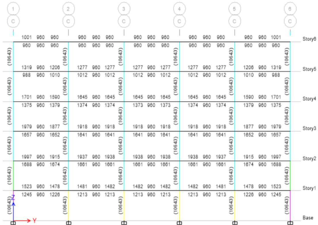
Ilustración 20: Refuerzo en vigas, eje C.
