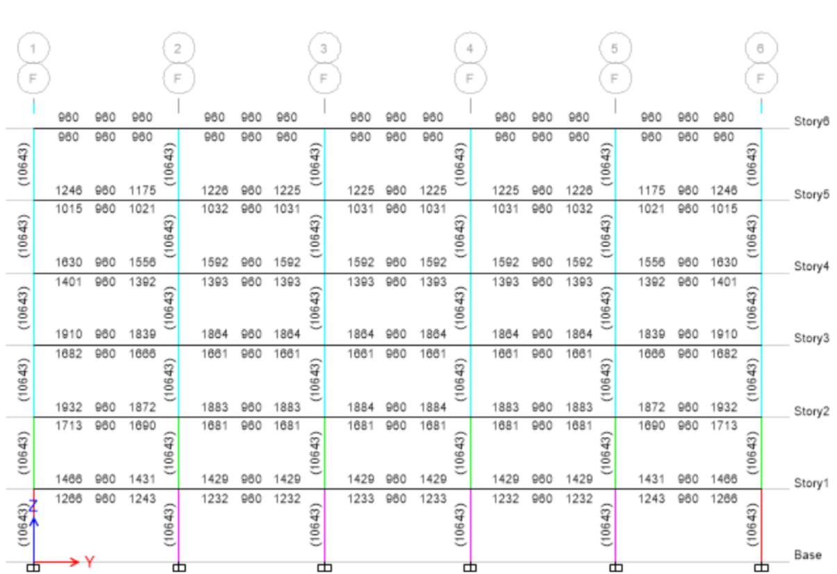
Ilustración 23: Refuerzo en vigas, eje F.
