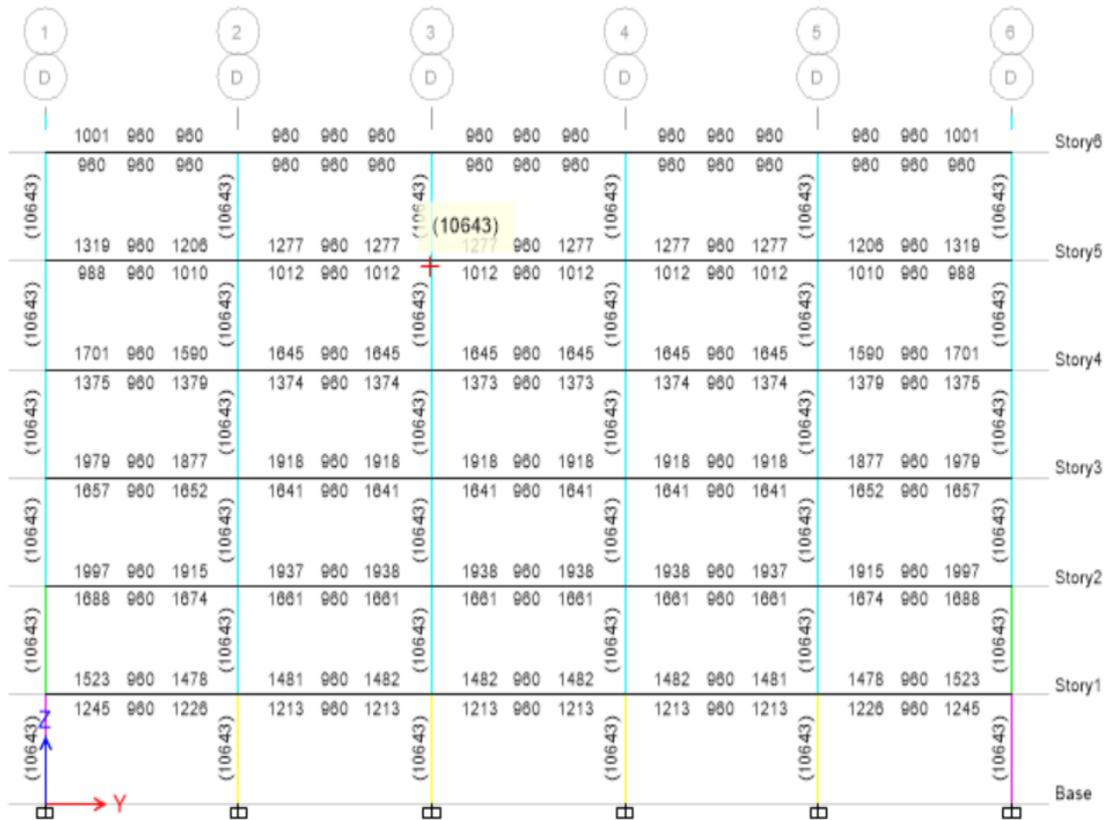
Ilustración 21: Refuerzo en vigas, eje D.
