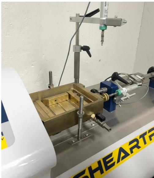
Ilustración 24. Caja de corte retirada
