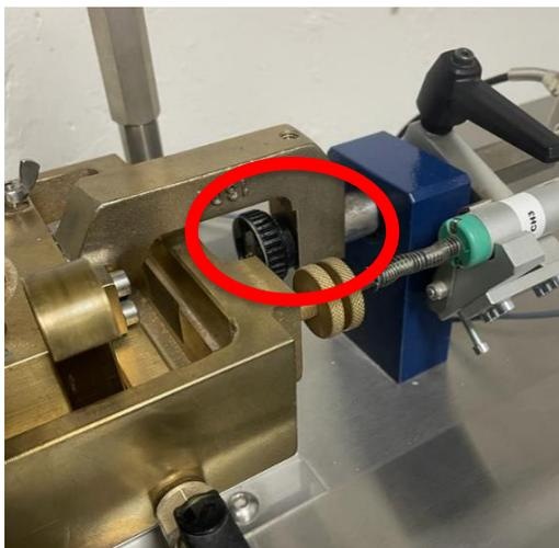
*Ilustración 32. Perilla para el ajuste de la caja de corte.*
