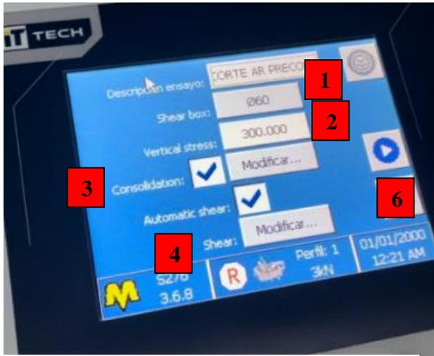
Ilustración 38. Diámetro de la caja de corte y esfuerzo normal.
