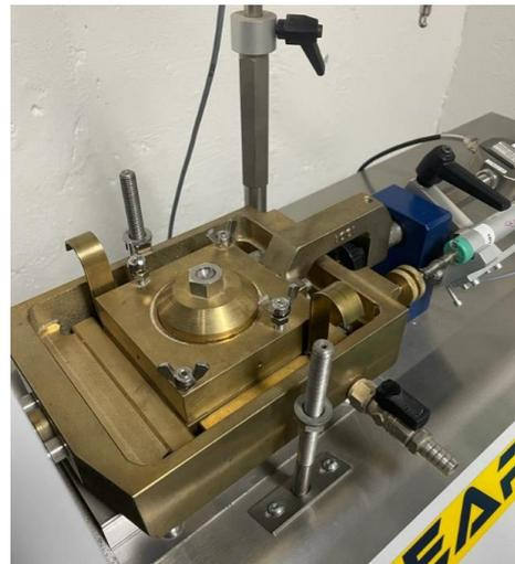
*Ilustración 33. Caja de corte junto con la muestra de análisis dentro del equipo.*
