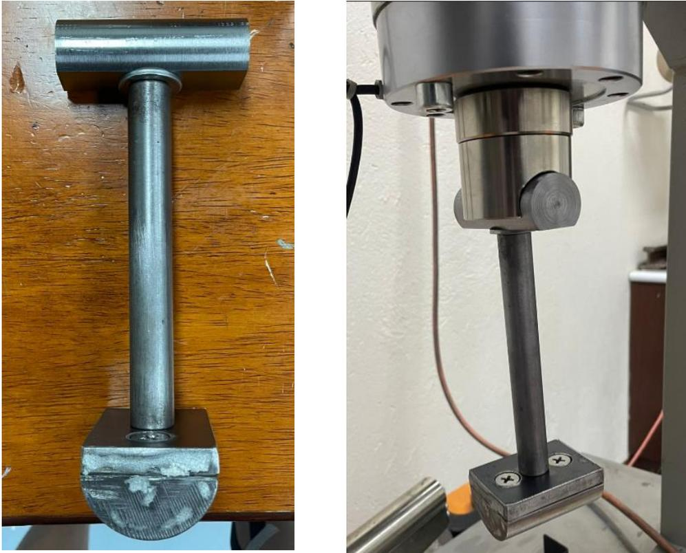
*Ilustración 5. Acople construido y colocado en la cabeza de la prensa hidráulica*
