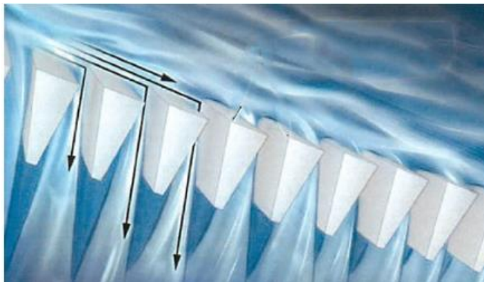
Ilustración 2 - Rejilla tipo coanda
