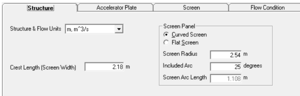
Ilustración 7 - Estructura rejilla coanda en programa
