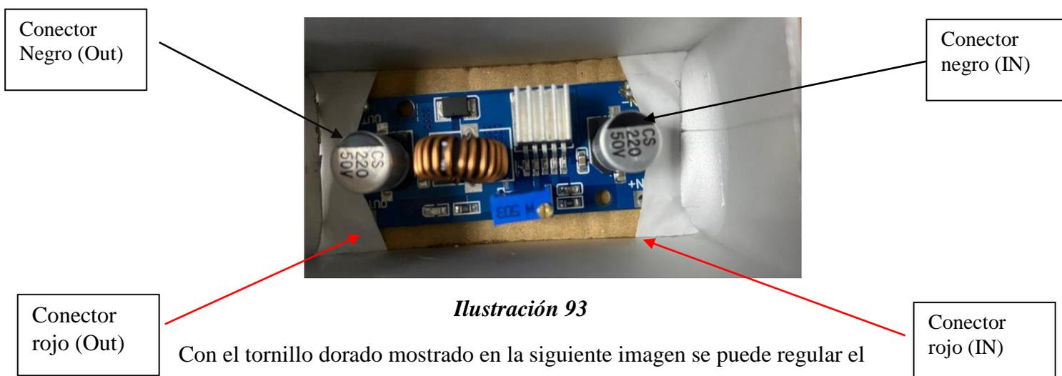
Mientras se gira en sentido horario, el voltaje aumenta, y cuando se gira en sentido anti horario el voltaje disminuye. (Ilustración 94).
