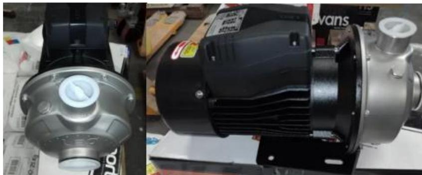
*Ilustración 50: Bomba centrífuga leo*
