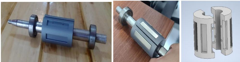
*Ilustración 16: Rotor con imanes permanentes*
