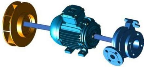
*Ilustración 7: Bomba y Turbina conectados por un eje pasante.*
