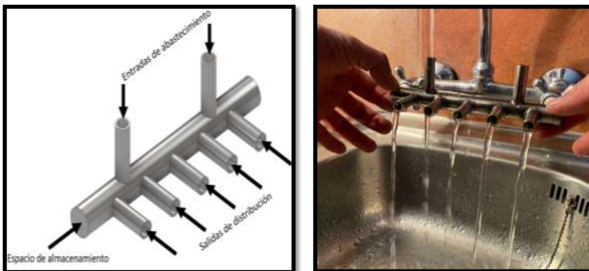
Figura 51 Distribuidora con espacio de almacenamiento cilíndrico con radio menor (distribuidora c)
