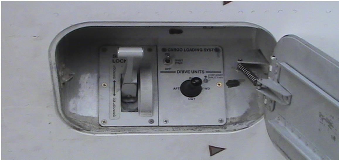
Los transportadores electromecánicos en las bodegas de los aviones **Airbus A340** permiten a través de sus controles manejar los contenedores desde el interior del avión.
