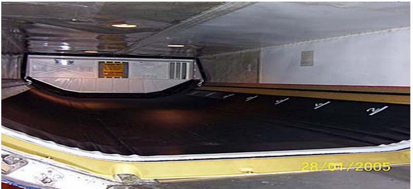
Esquema del sistema de acarreo de equipaje en las bodegas de un Boeing 757
