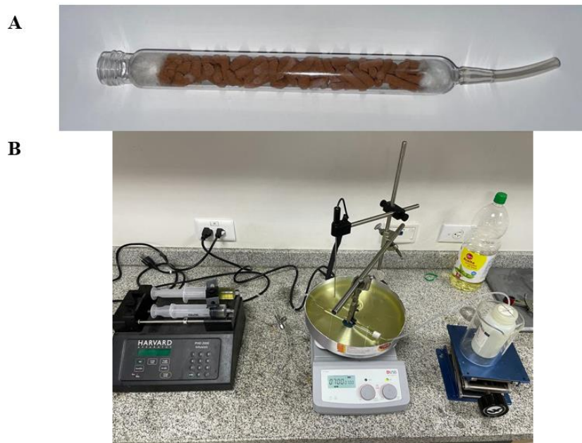
Figura 10. Construcción del sistema. A) Reactor empaquetado, B) Configuración del sistema
