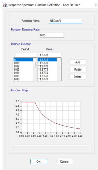
Figura 22 Definición espectro elástico de diseño en ETABS
