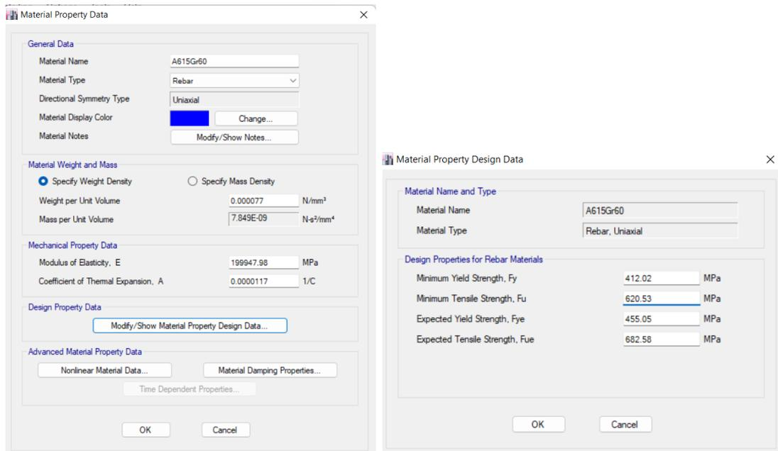
Figura 11 Definición acero estructural  $f_y=4200 \text{ kg/m}^2$
