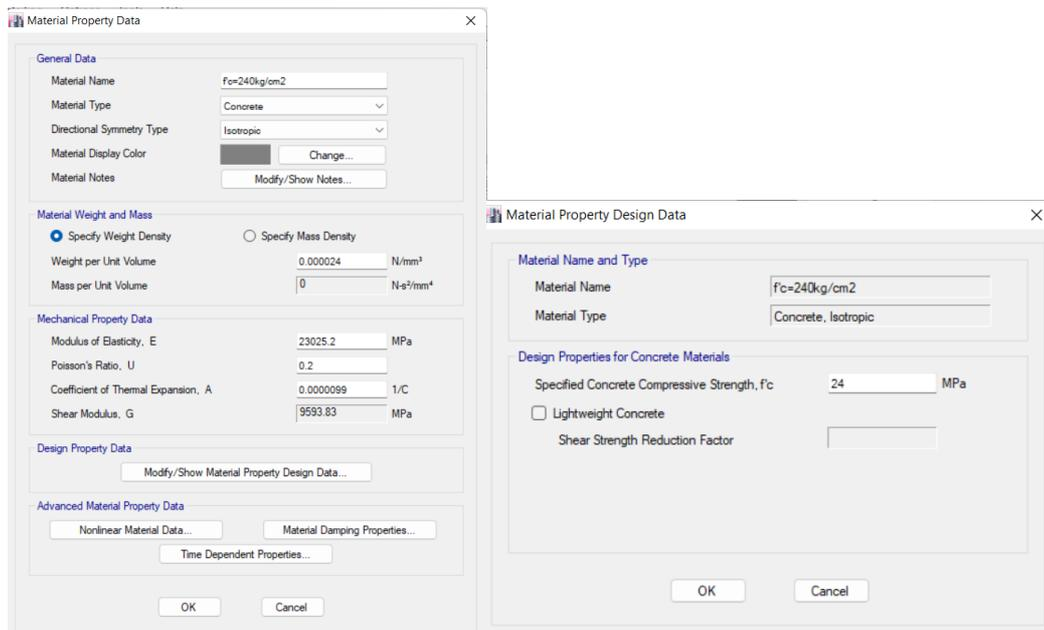
Figura 10 Definición hormigón  $f'c=240 \text{ kg/cm}^2$
