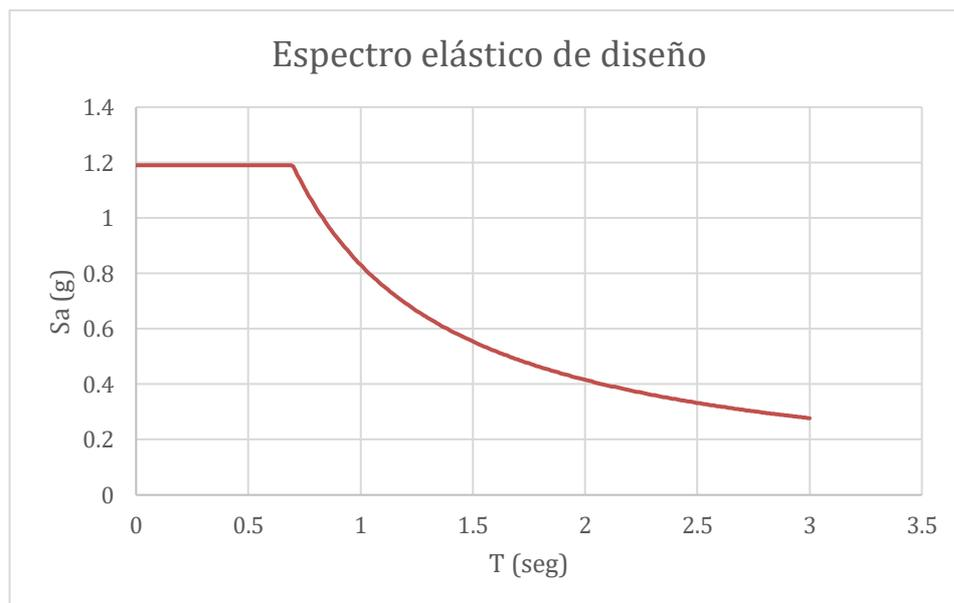
*Figura 6 Espectro elástico de diseño en aceleraciones*
