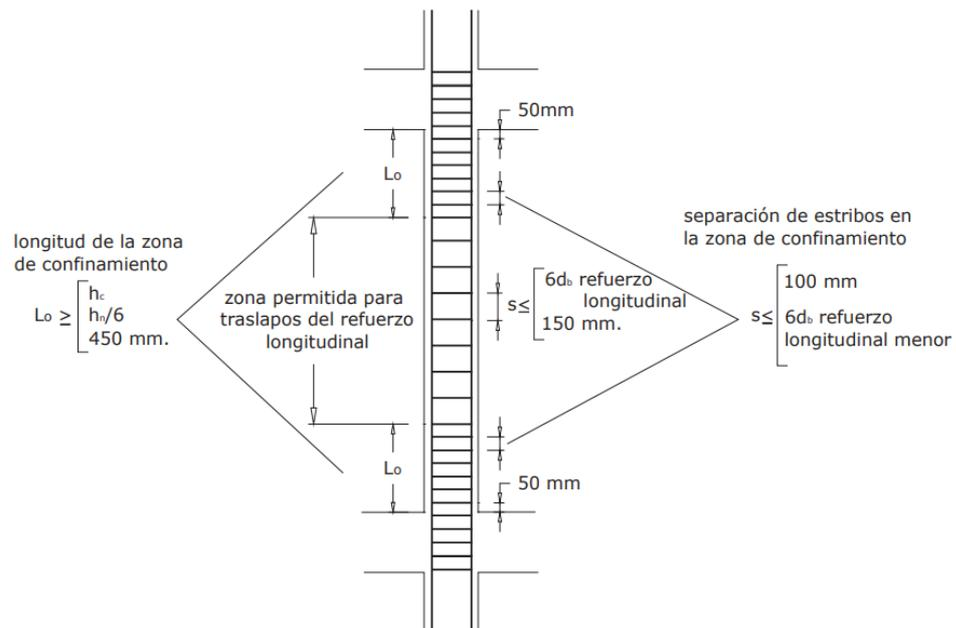
Figura 40 Longitud de confinamiento (MIDUVI, 2015)
