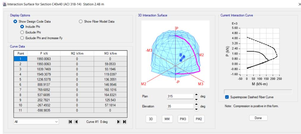
Figura 39 Diagrama de interacción ETABS
