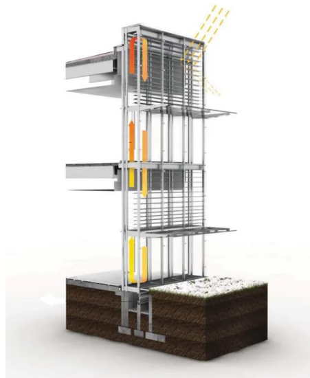
Figura 12. Un diagrama de invierno del sistema de pared, atrapando el aire caliente y usándolo como amortiguador aislante. William Rawn Associates
