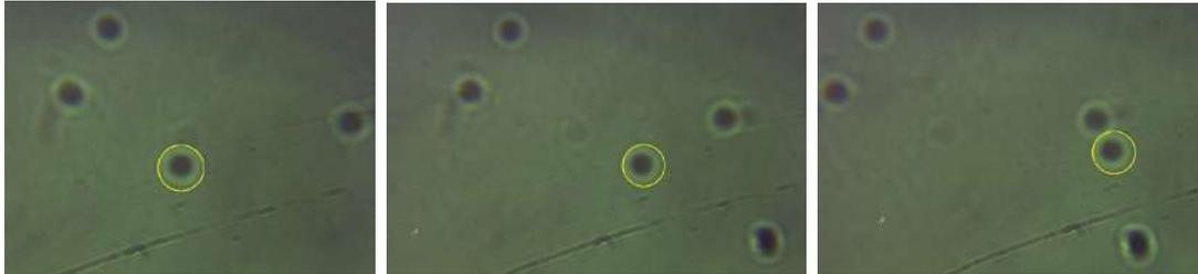
Figura 3.3: Fotogramas del video que muestran el confinamiento y la manipulación de una partícula de silica (círculo amarillo) de  $2 \mu\text{m}$   $\varnothing$ .
