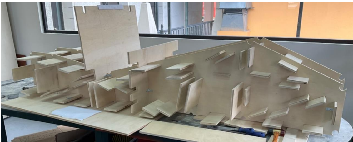
Figura 15. JIG de fabricación de madera totalmente armado.
