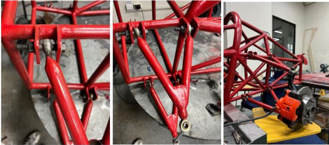
Figura 19: Montaje de las mesas al chasis mediante las juntas emperradas.
