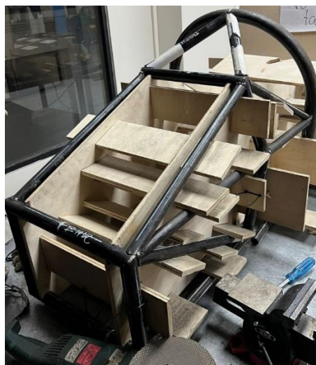
Figura 17. Posicionamiento de tubos en el JIG de fabricación.
