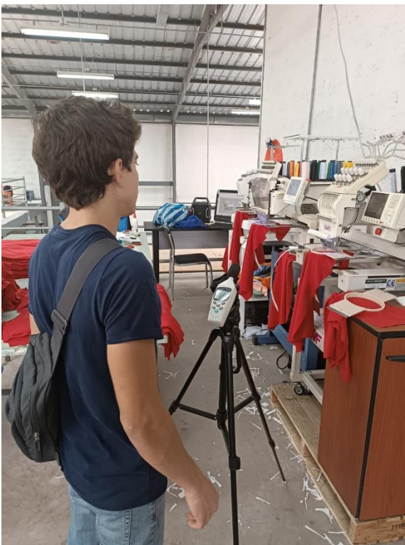
Figura 15: Medición de ruido en área de producción
