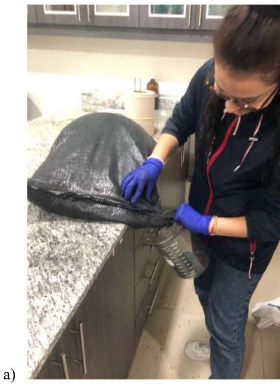
Figura 19. Preparación filtro carbón activado
