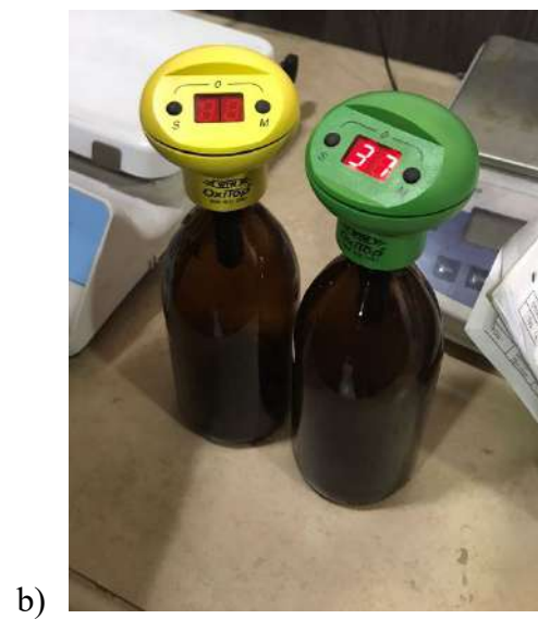
Figura 24. Determinación DBO5 con el equipo OxiTop
