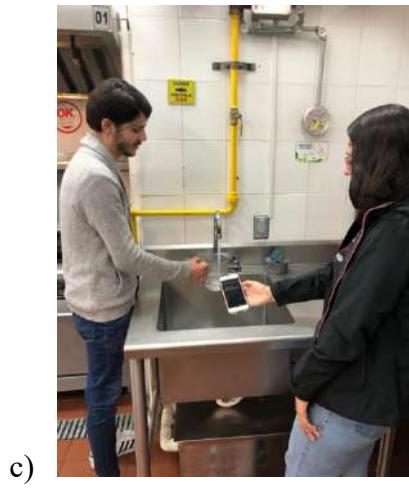
Figura 23. Toma de muestras de las cocinas de la USFQ y determinación del caudal
