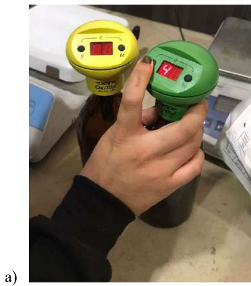
Figura 24. Determinación DBO5 con el equipo OxiTop
