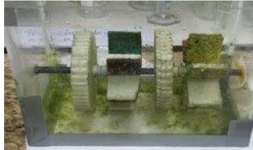
Día 20 Reactor Fijación biofilm, vista frontal
