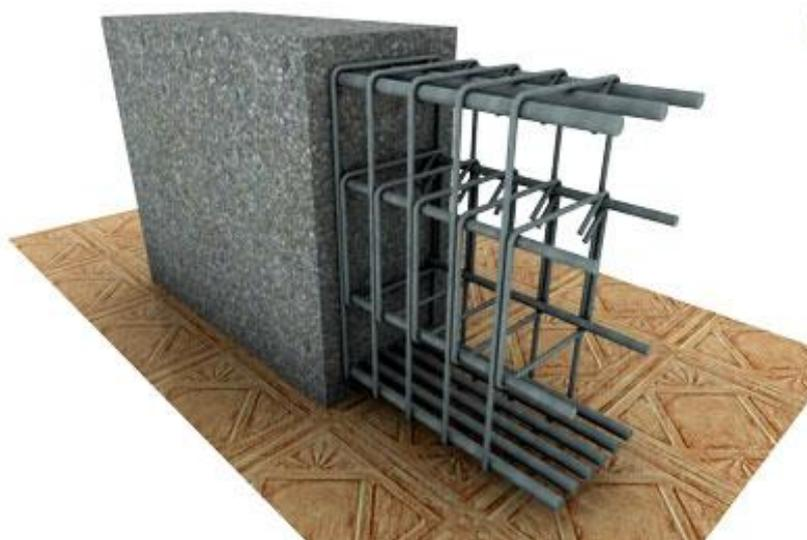
*Ilustración 70: Sistema Constructivo Hormigón Armado*
