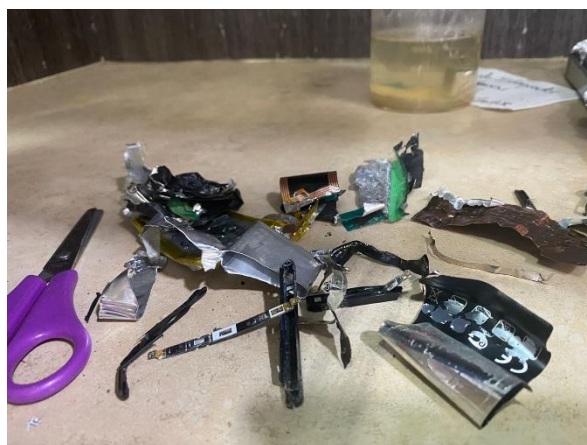
Figura 5: Desmantelamiento manual de BIL
