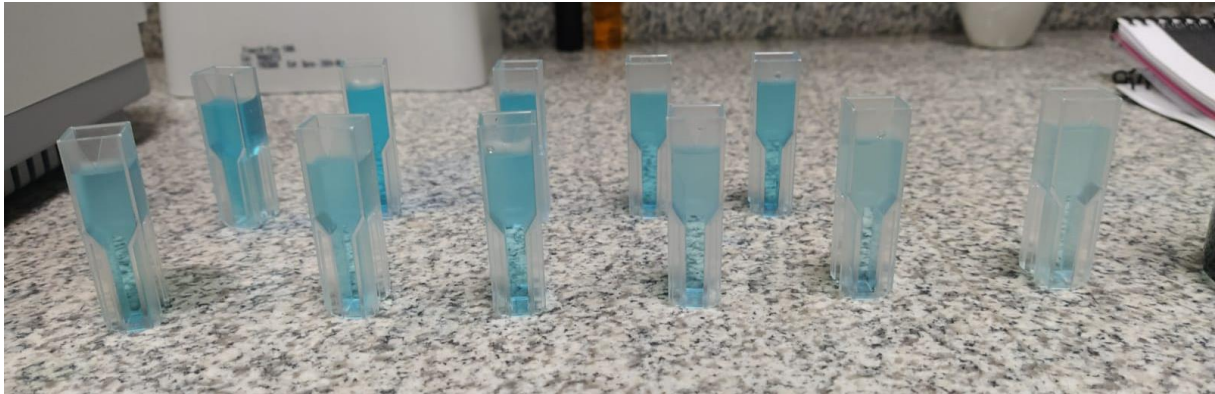
Figura 20. Imagen de la recolección de muestras para la adsorción de azul de metileno.
