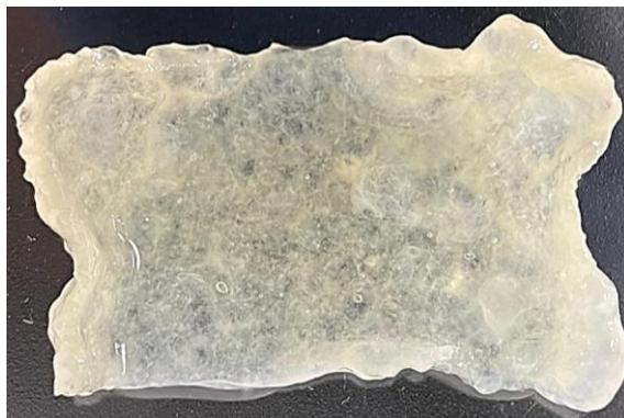
*Figura 16. Parche sin tratamiento mecánico sometido a prueba de hinchamiento por 48 horas en PBS 1X a 37°C.*
