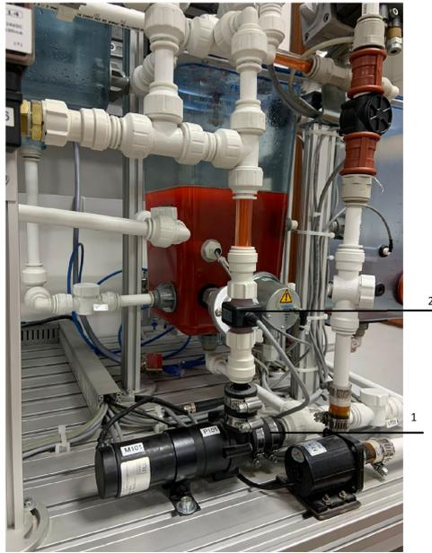
Figura 1.4: Bomba P101 con sensor de flujo B102
