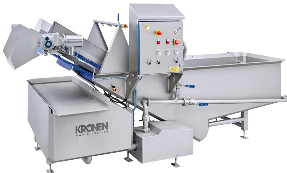
Figura I 4. Especificaciones de tanque de desinfección para frutillas.
