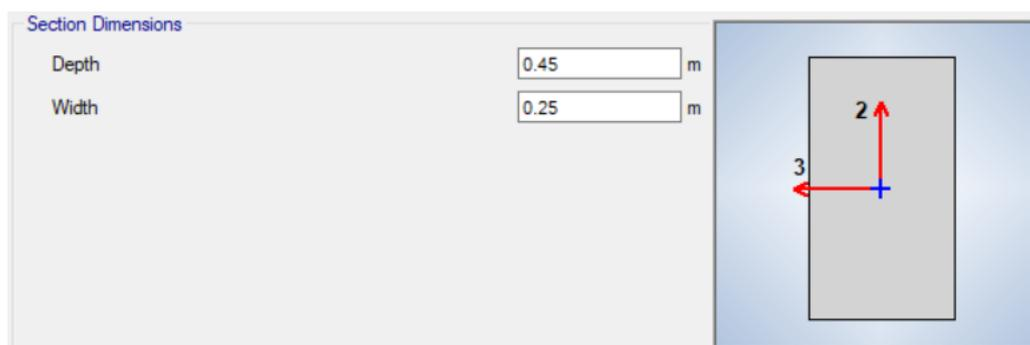
*Figura 8 Predimensionamiento Viga 25x45cm*
