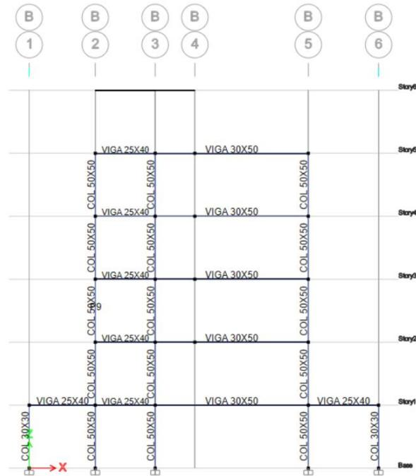
Figura 64 ETABS: Vista Corte B-B
