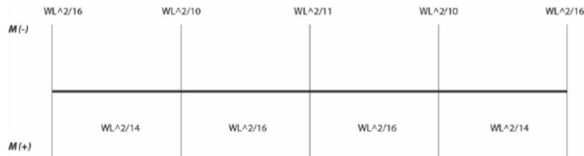
*Figura 6 Momentos en una viga, dirección X*
