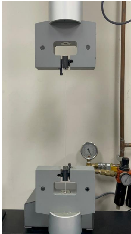
Figura 13. Ensayo de Tracción a una Fibra Óptica
