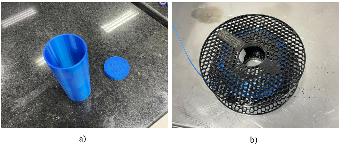
Figura 3. (a) Encofrado de cilindro impreso con dimensiones 21.9 cm de junto a (b) un rollo de filamento de PLA con diámetro de 1.75 mm
