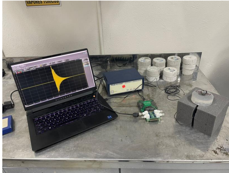
Figura 5. Equipos utilizados para la medición del módulo de elasticidad dinámico. De derecha a izq: Disco con bola de acero para impacto, amplificador de senao (azul) y recetor de señal (verde) y decodificador de señal (Laptop).
