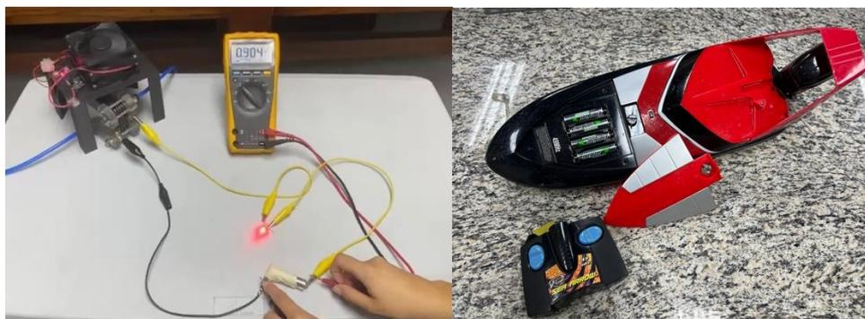
*Figura 32 Prototipo para la implementación de la energía generada por la PEMFC*
