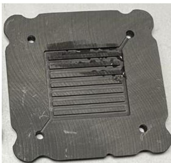
*Figura 30 Residuos de producto  $H_2O$  en configuración PM*
