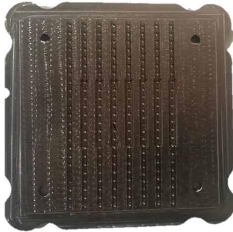
*Figura 31 Perforaciones en canales configuración MM (material: acero inoxidable 316L)*
