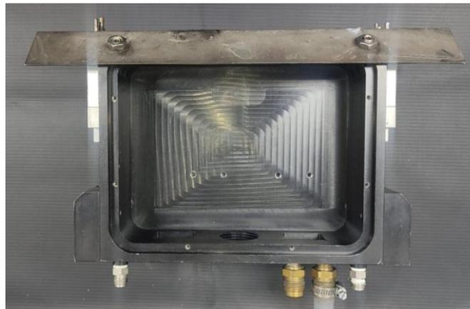
*Figura 4 Prototipo de sensor ICP (vista superior)*
