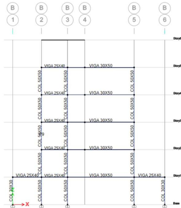
Figura 64 ETABS: Vista Corte B-B
