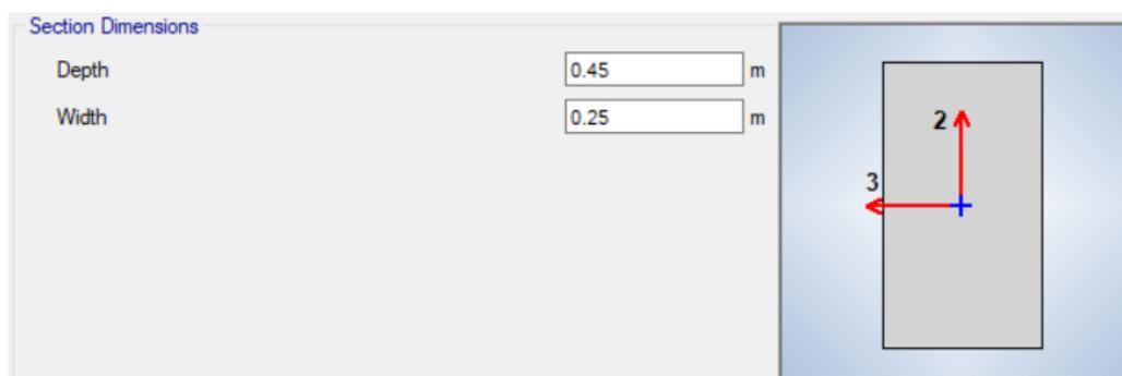
*Figura 8 Predimensionamiento Viga 25x45cm*
