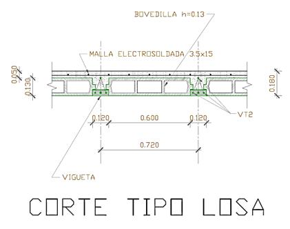
Gráfico 88: Detalle de Sistema Constructivo de Losa Prefabricada
