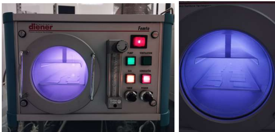
Figure 2.5: A la izquierda se observa la foto frontal de la máquina de plasma en funcionamiento. A la derecha se observa una foto del plasma sobre la superficie de las muestras.
