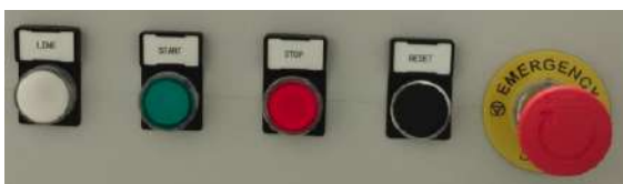
Figure 2.12: Se observa los diferentes botones para iniciar y terminar con un proceso de Sputtering.
