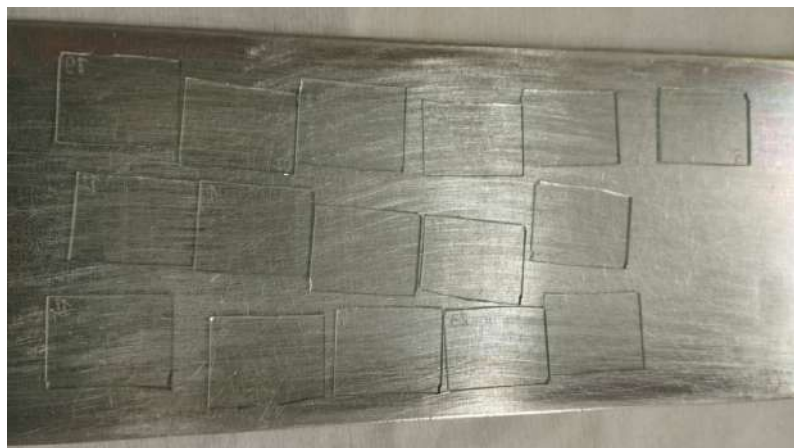
Figure 2.3: Laminillas cortadas sobre la bandeja de la máquina de plasma.
