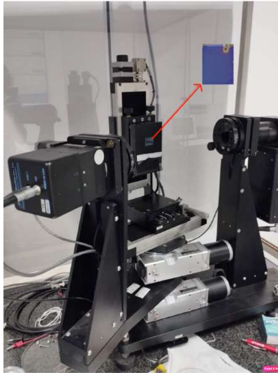
Figure 2.14: Esquema del elipsómetro utilizado para caracterización de muestras obtenidas por el Sputtering.
