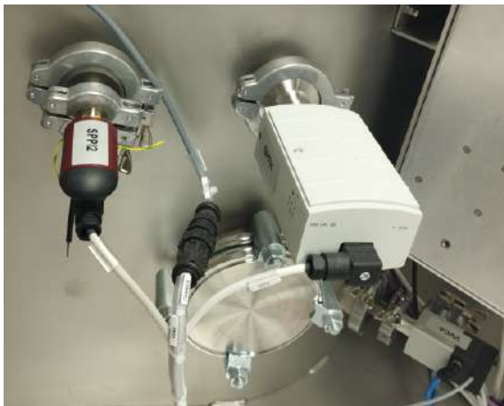
Figure 2.11: Se observa los diferentes sensores de presión y temperatura de la máquina.
