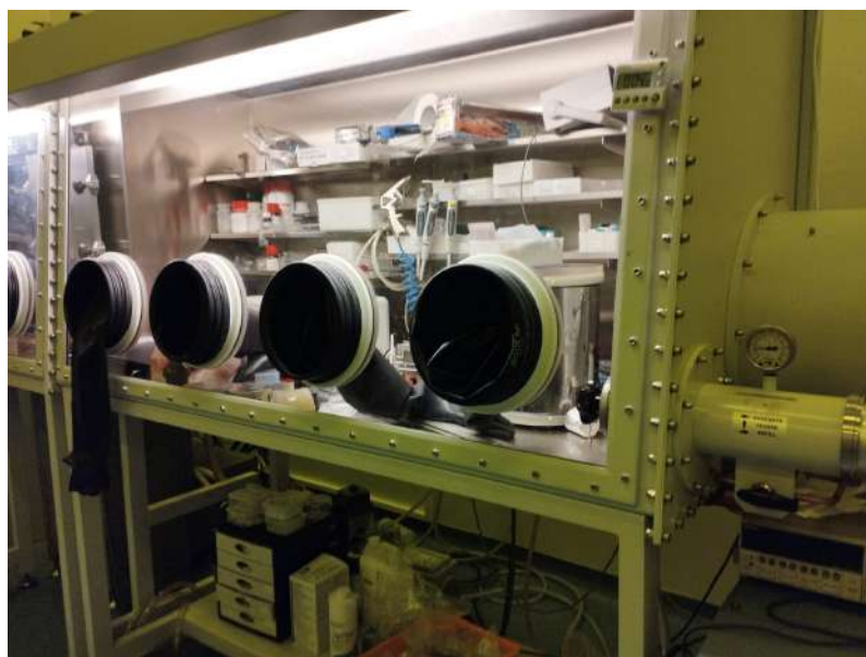
Figure 2.4: Cámara seca para evitar contaminaciones y degradación de muestras.
