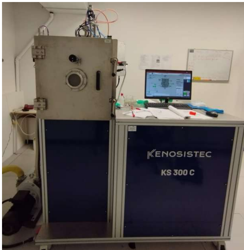
Figure 2.6: Foto del equipo utilizado (KENOSISTEC KS 300C) para la realización de la pulverización catódica con magnetrón (CC y RF).
