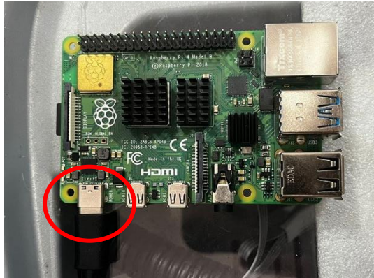
Figura 39: Conexión del segundo Raspberry.
