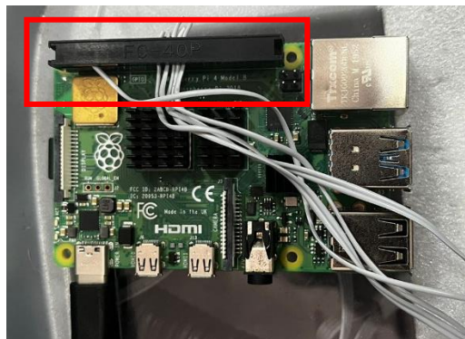
Figura 40: Conexión del Raspberry con el módulo de expansión CAN.
