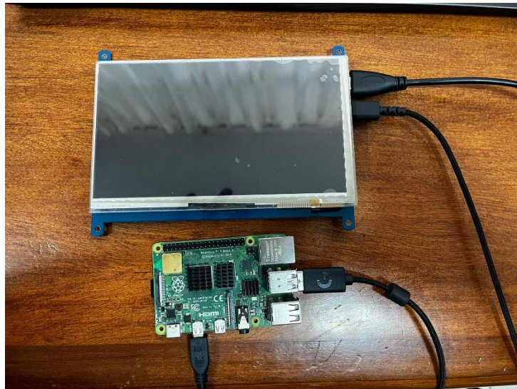
Figura 22: Conexión entre el Raspberry y la pantalla.
