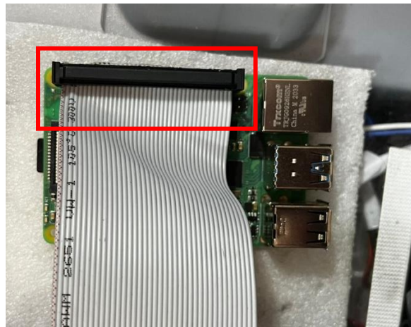
Figura 20: Conexión del bus de datos del Raspberry Pi 4B.
