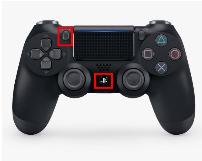
Figura 28: Emparejamiento Bluetooth del mando con el Raspberry.
