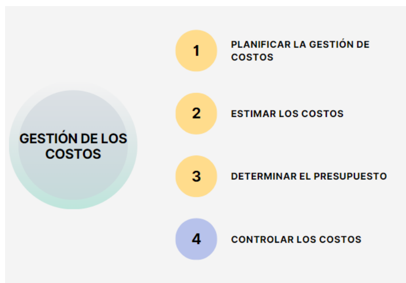
Ilustración 175: Procesos necesarios para ejecutar gestión de costos del proyecto. Fuente: (Documentación del PMI, 2023)
