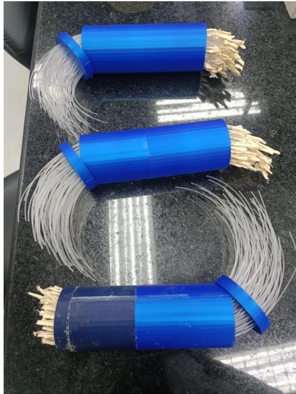
Figura 3: Imagen de los cilindros de 3%, 4% y 5% de fibra óptica plástica (sin fundir).
