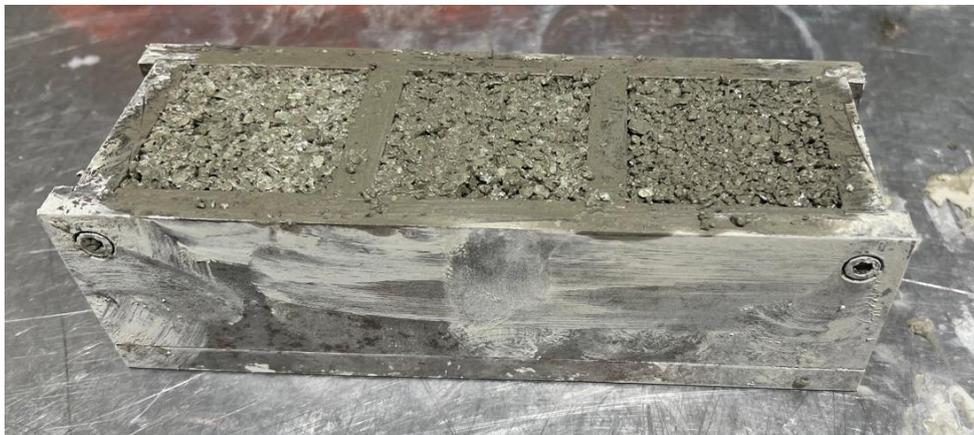
Figura 11: Encofrado para los especímenes fluorescentes de control, sin fibra óptica plástica.
