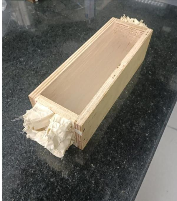
Figura 6: Encofrado de vigueta de 5% de fibra óptica plástica, diseñado en madera.
