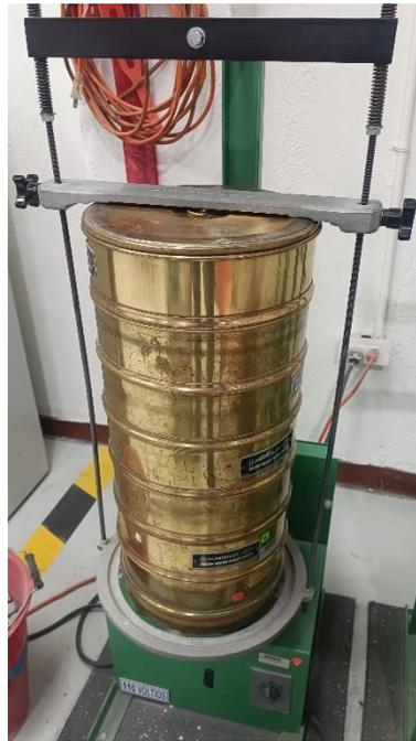
Figura 14: Proceso de tamizado del agregado fluorescente.
