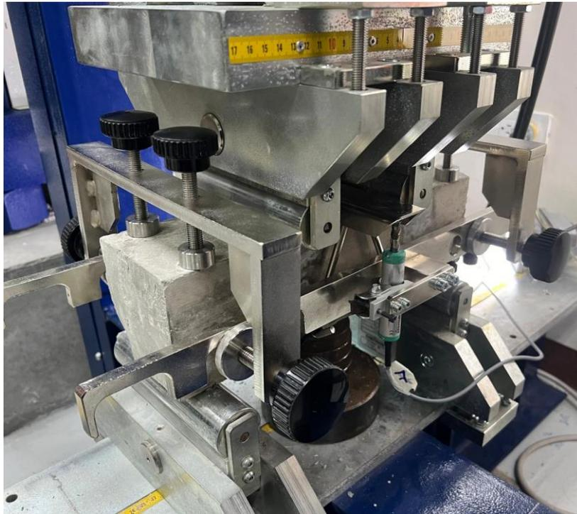
Figura 9: Colocación de la vigueta en la máquina del ensayo a flexión.
