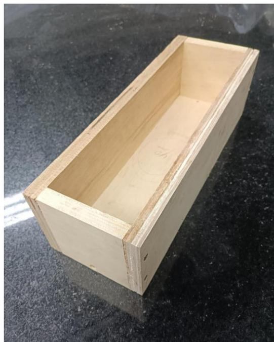
Figura 7: Encofrado de vigueta de muestra control y de fibras de polipropileno, diseñado en madera.
