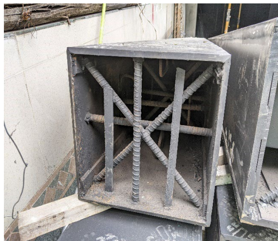
b) A partir de cuatro placas soldadas
