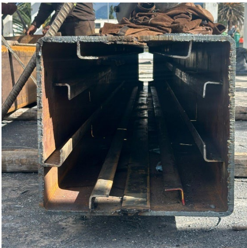
a) A partir de dos perfiles C
