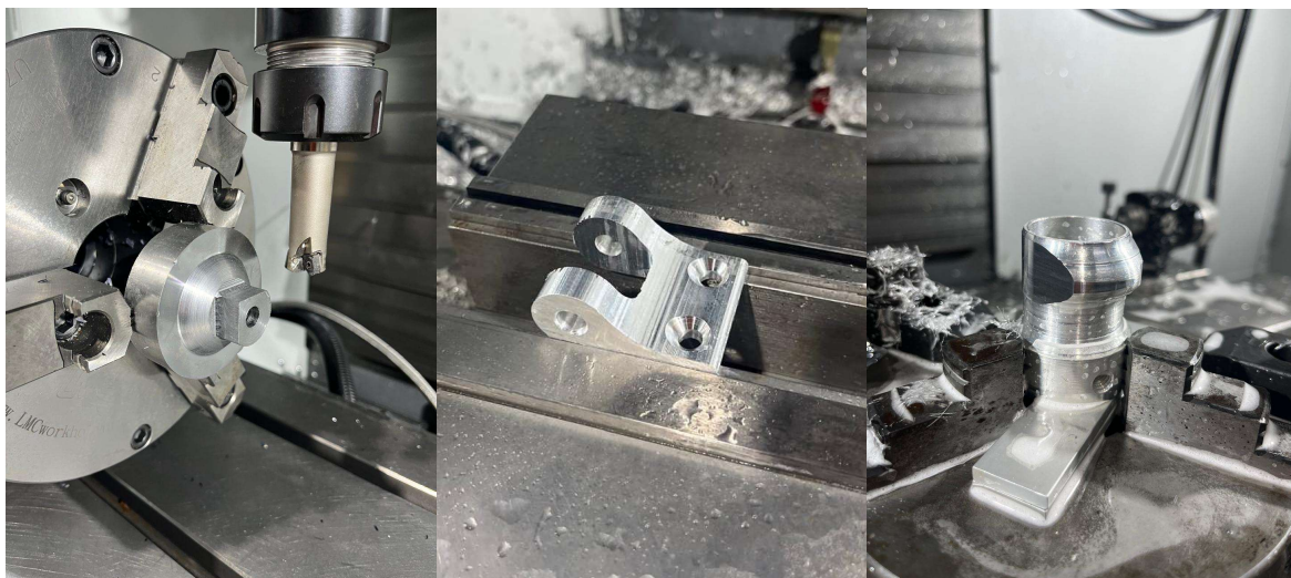
Figura 13 Piezas metálicas maquinadas en la fresa CNC. Pirámide (izquierda), base del amortiguador (centro), acople de tibia (derecho).
