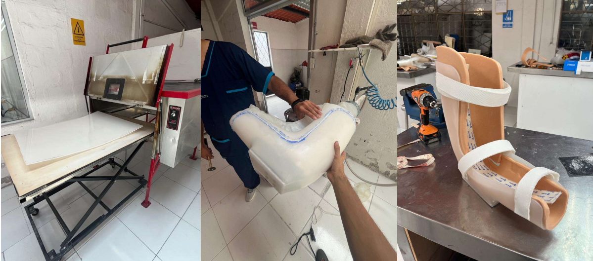
Figura 16 Fabricación del socket. Calentado del plástico en horno, termoformado al vacío, y acople de bandas de sujeción. Finalmente, se emperna el acople empra para la pirámide en los agujeros previamente taladrados sobre el socket y la placa metálica. Con esto, se da por completado el proceso de producción del socket en forma de L que se usara para realizar el acople integral de la pierna protética. Este proceso se detalla en el siguiente diagrama de procesos.
