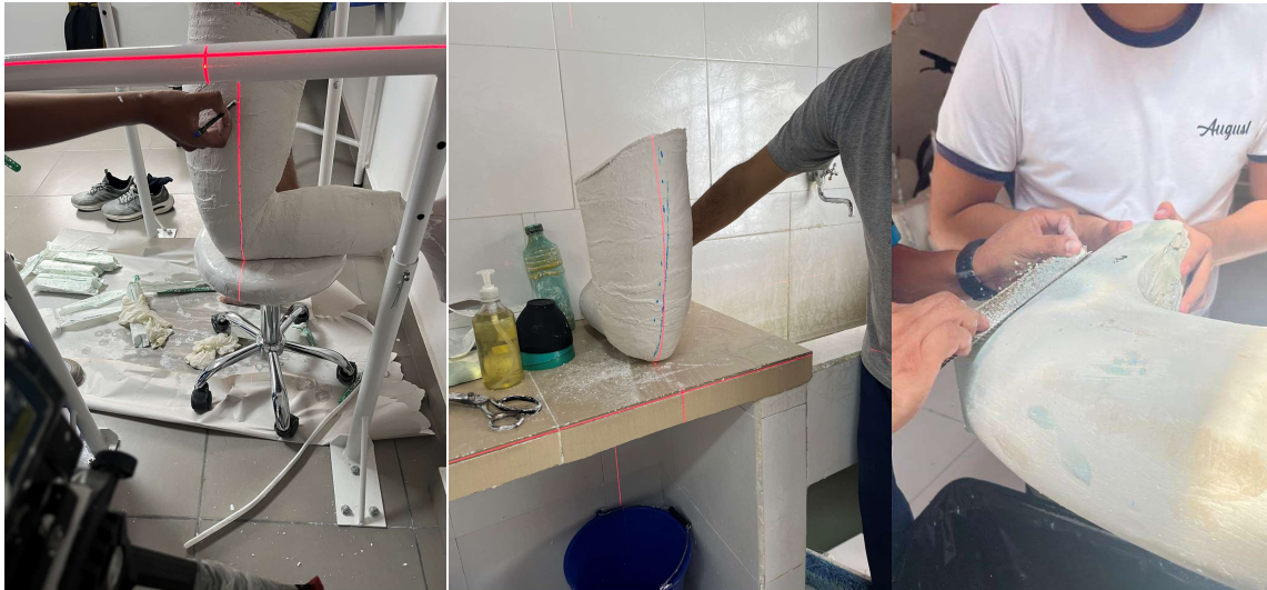
Figura 15 Manufactura del molde de yeso para termoformado. Vendado, alineación y pulido.
