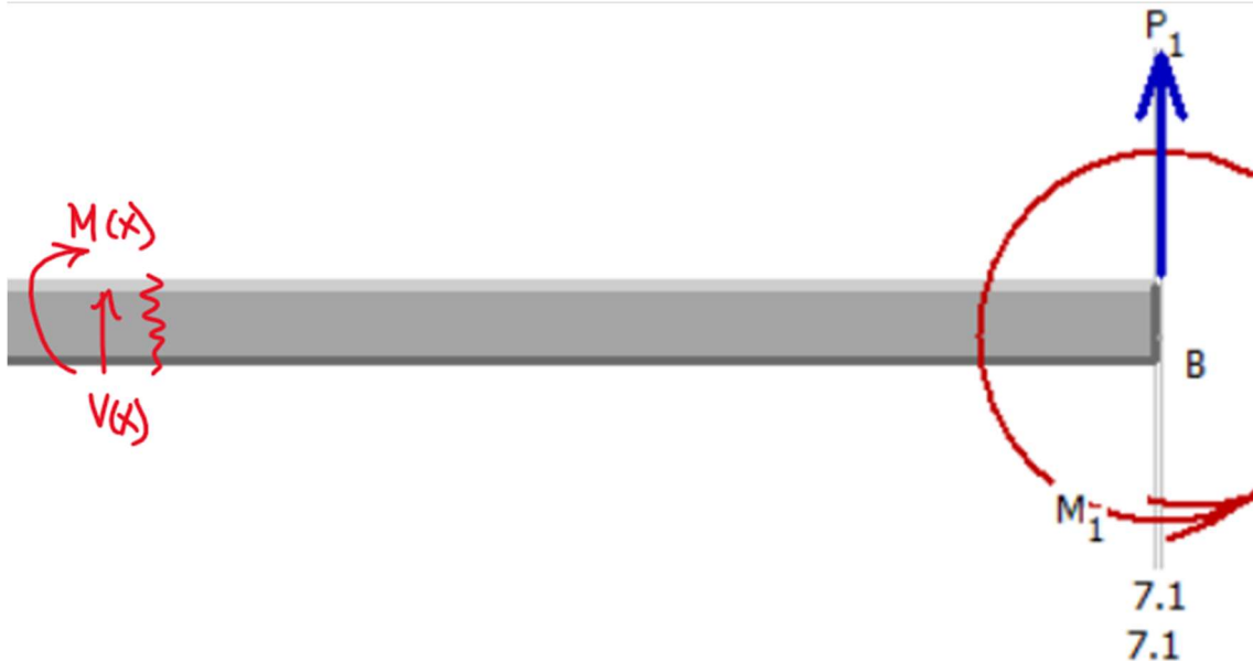
Figura 66 Corte para el cálculo de la deflexión.
