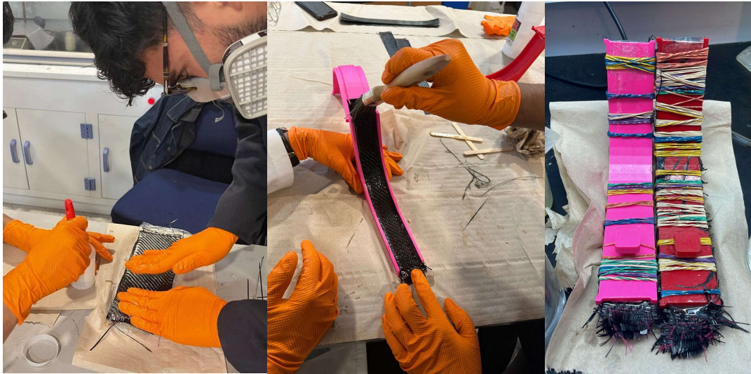
Figura 21 Moldeado de fibra de carbono con resina epoxi
