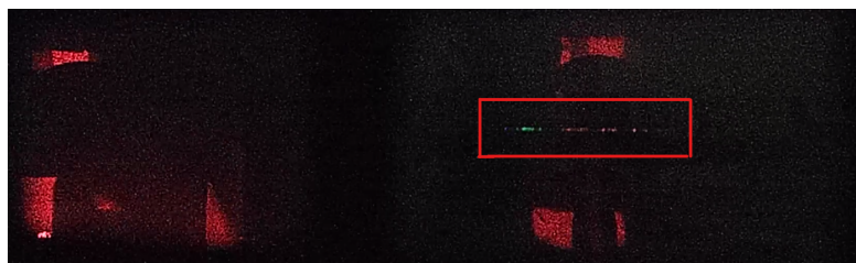
Figura 2.4: Señal Raman del cloruro de polivinilo captada con una cámara digital
