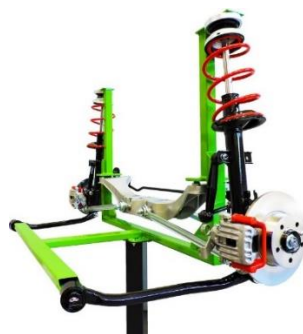
Figura 3. Suspensión Multilink (Nada, n.d.)
