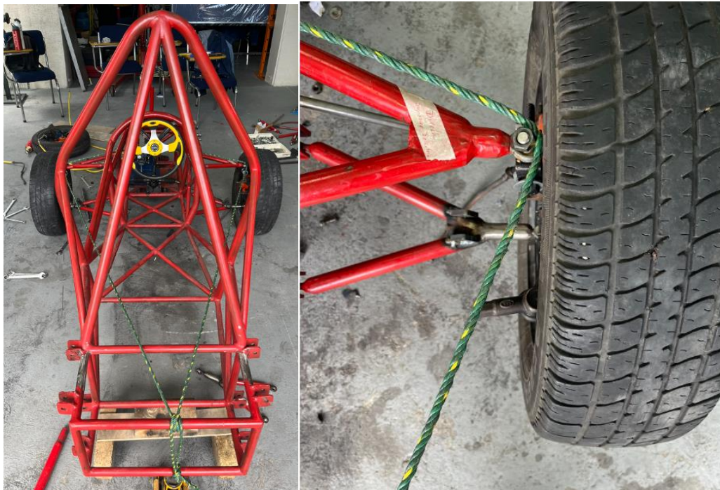
Figura 61. Principio de Ackerman
