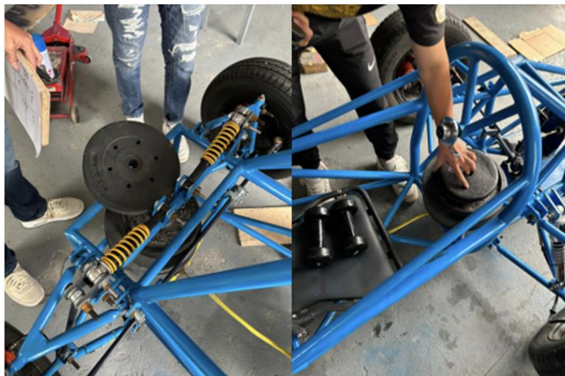
Figura 87. Prueba de carga
