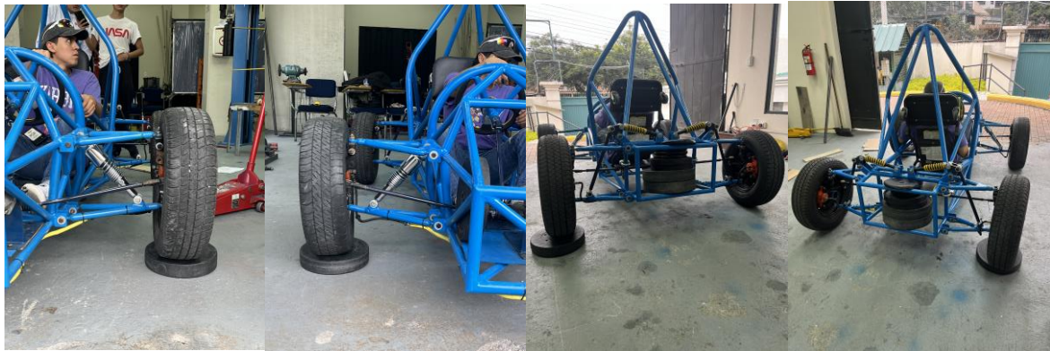
Figura 88. Prueba de articulación
