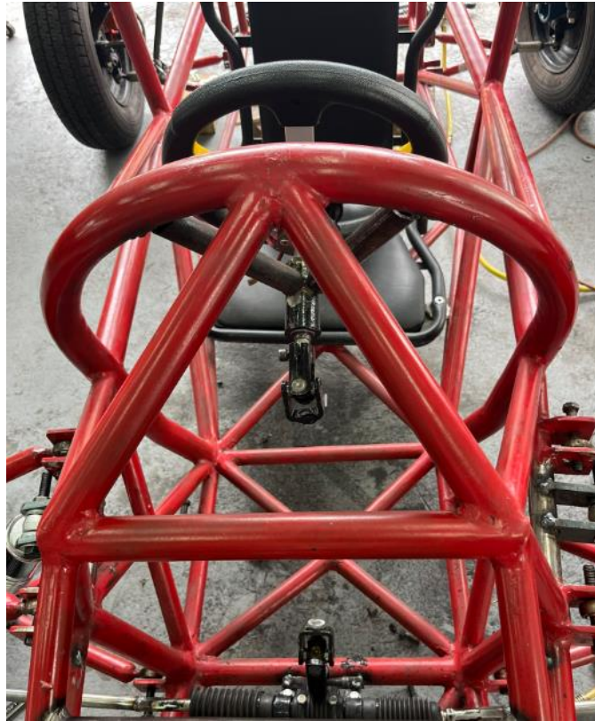
Figura 63. Sistema de dirección en su posicionamiento final
