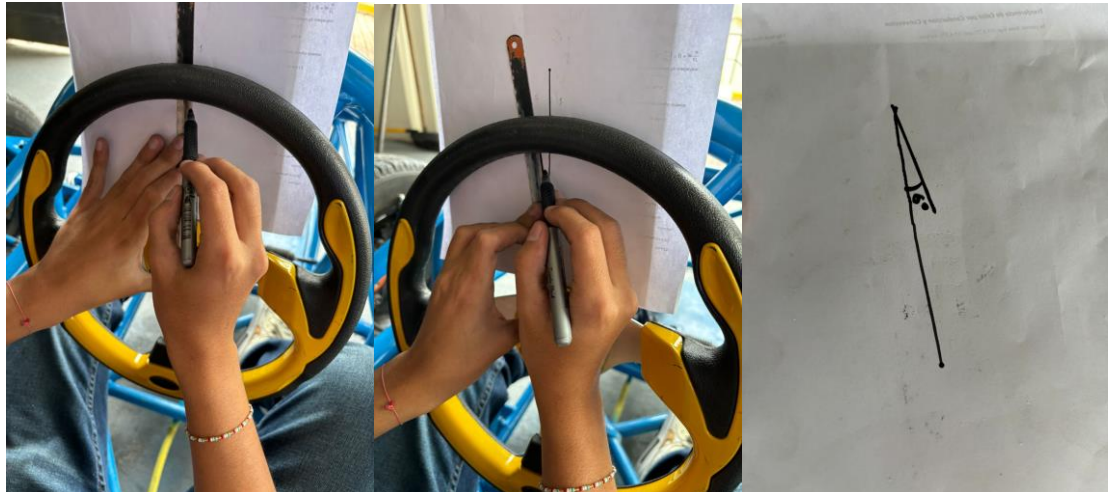
Figura 80. Ángulo de giro libre del volante
