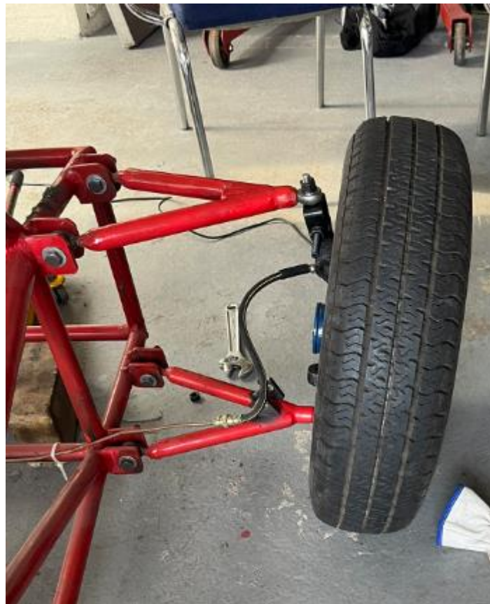
Figura 60. Ángulo de camber del monoplaza
