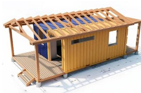
*Figura 20 Contenedor como método de construcción*
