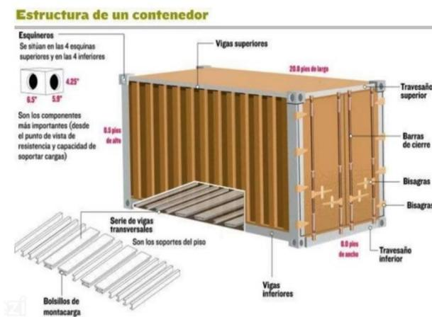
Figura 18 Estructura del Contenedor
