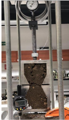
Figura # 8- Probeta ensayo sin fibra
