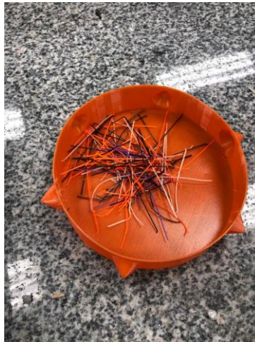
Figura # 10- Fibra sintética utilizada
