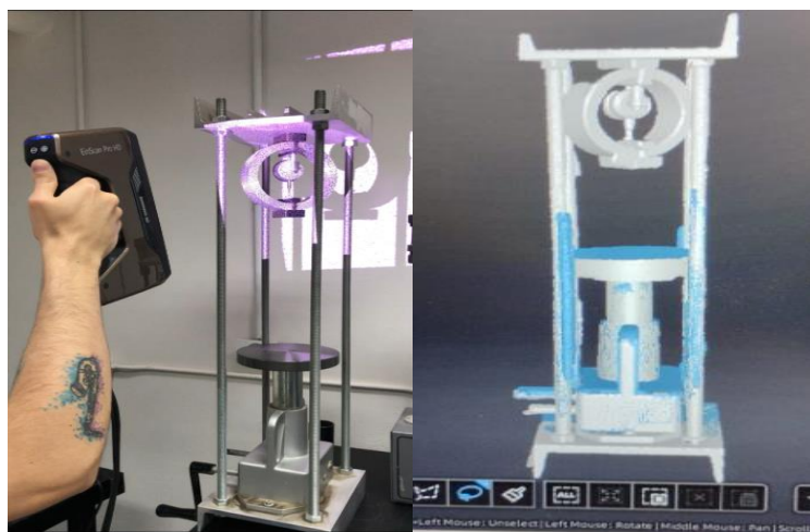
Figura # 1- Escaneo y modelado 3D de la maquina
