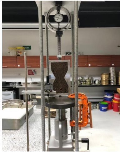
Figura # 12- Probeta ensayo con fibra
