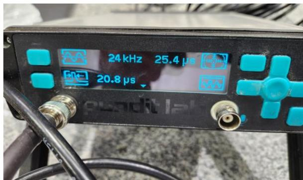
Figura 18. Equipo Pundit Lab de Ultrasonidos.
