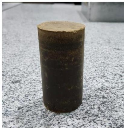
Figura 15. Muestra de Suelo Compactado.
