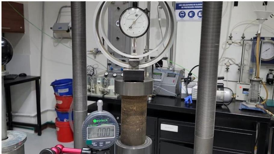
Figura 17. Ensayo de Compresión Inconfinada
