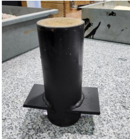
Figura 14. Molde Cilíndrico de Diámetro 50mm.
