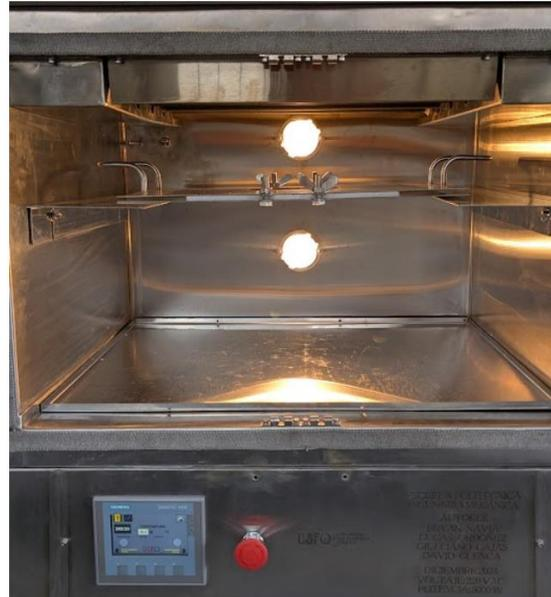
El Horno de Termoformado es un sistema de calentamiento enfocado en el termoformado de cualquier plástico con el objetivo principal de fabricar sockets protéticos. El Horno se diseñó y construyó como proyecto de titulación en Ingeniería Mecánica de la Universidad San Francisco de Quito.
