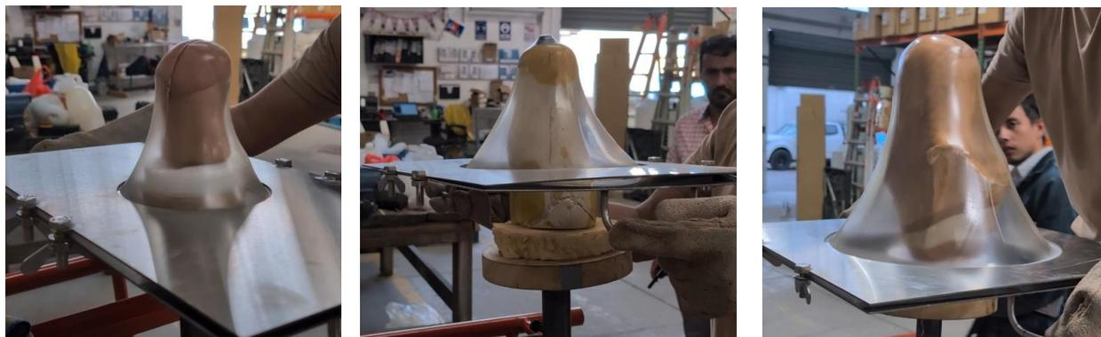
*Figura 50 Colocación de plástico en los moldes*
